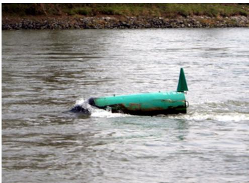
**linke Seite** des Fahrwassers (unabhängig von der momentanen Blickrichtung immer in Richtung der Strömung zu sehen):
